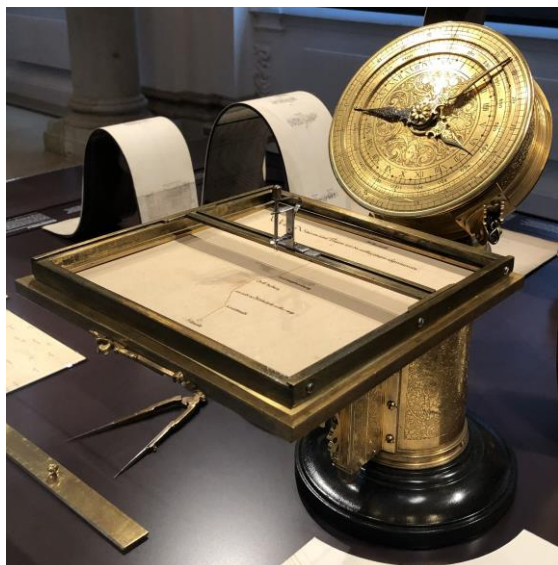
図10 1584年作の馬車用走行距離計
