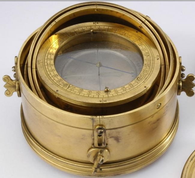
図9 アウグストが使ったジンバル付きコンパス 図7の絵巻物の中心に描かれているコンパスローズと同じもの。アウグストは色々なコンパスを使用した。中心部の分割が一致していることからこのジンバル付きコンパスを使用したことがわかる。 デンマーク製か、1588年作、真鍮製金メッキ及び銀メッキ加工、数学物理サロン博物館提供。
